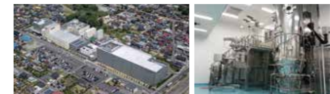
流動層造粒ライン / Tumbling fluidized bed granulator
